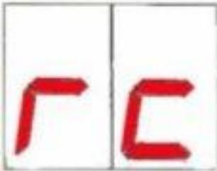
**FR** Si à la fin de l'étalonnage le display affiche "rc", appuyer sur le bouton Cal pour revenir à la lecture. Répéter la procédure d'étalonnage, si le message "rc" réapparaît, cela signifie que l'électrode n'est pas en bon état et qu'elle doit être changée.
