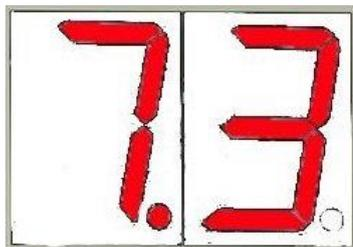
**FR** Pendant le fonctionnement, la valeur de pH mesurée par la sonde sera visible sur le Display.
