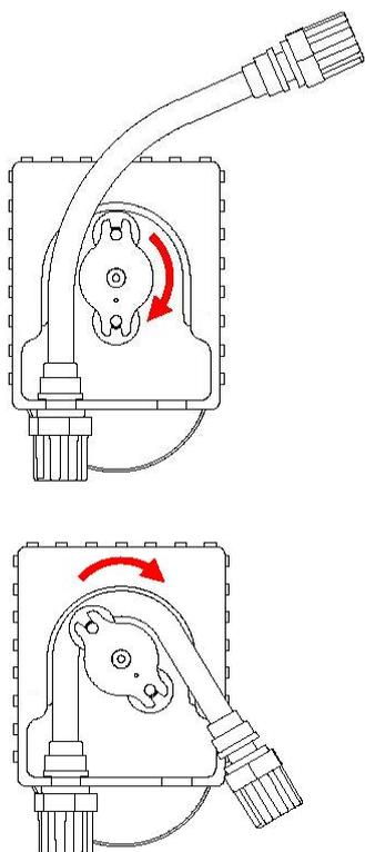
**FR** Positionner le raccord de gauche du nouveau tube péristaltique dans l'encoche prévue à cet effet. Faire attention à ce que la partie arrondie soit orientée vers l'intérieur. Tourner le porte-galet dans le sens horaire de façon à ce que le tube péristaltique se mette naturellement en place. Ne jamais tourner à contre-sens.
