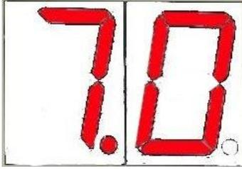
**PO** Pressione a tecla Cal por 3 segundos, no visor, o valor de 7.0 começará a piscar. Quando a calibração da sonda estiver concluída, o valor no monitor será fixado
