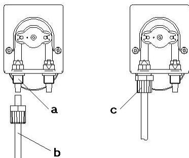
**FR Aspiration :** Raccorder le tuyau d'aspiration (b) au raccord d'aspiration (a).
