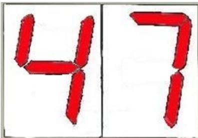
**DE** Drücken Sie die Taste CAL für 3 Sekunden. Am Display beginnt der Wert 470 zu blinken. Sobald die Kalibrierung der Rx-Sonde abgeschlossen ist, blinkt der Wert nicht mehr und ist fest.
