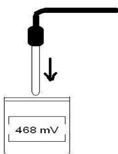
**FR** Insérer la sonde de Rx dans la solution tampon à 468mV. Attendre quelques secondes pour la stabilisation de la lecture.
