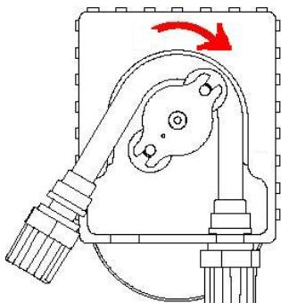
**FR** Décrochez le couvercle avant transparent en appuyant avec un point dans le trou entre les 2 raccords. Enlever le vieux tube en débloquant d'abord le raccord de gauche. Faire tourner le porte-galet dans le sens de la flèche jusqu'au raccord de droite afin de libérer le tube péristaltique.
