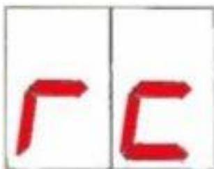
**FR** Si à la fin de l'étalonnage le display affiche "rc", appuyer sur le bouton Cal pour revenir à la lecture. Répéter la procédure d'étalonnage, si le message "rc" réapparaît, cela signifie que l'électrode n'est pas en bon état et qu'elle doit être changé.
