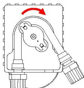
**FR** Positionner le raccord de gauche du nouveau tube péristaltique dans l'encoche prévue à cet effet. Faire attention à ce que la partie arrondie soit orientée vers l'intérieur. Tourner le porte-galet dans le sens horaire de façon à ce que le tube péristaltique se mette naturellement en place. Ne jamais tourner à contre-sens.
