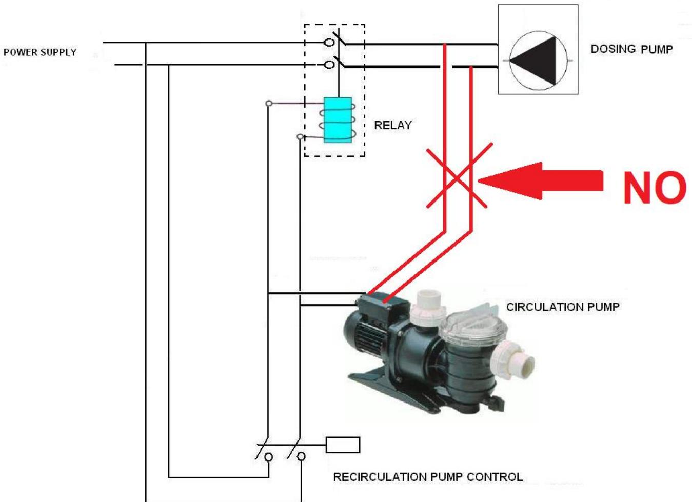
**FR** ! IMPERATIF ! La pompe ne doit injecter que lorsque de l'eau circule dans la canalisation.
