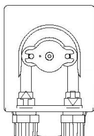
**FR** Insérer le raccord de droite dans l'encoche prévue. Positionner le couvercle sur la pompe.
