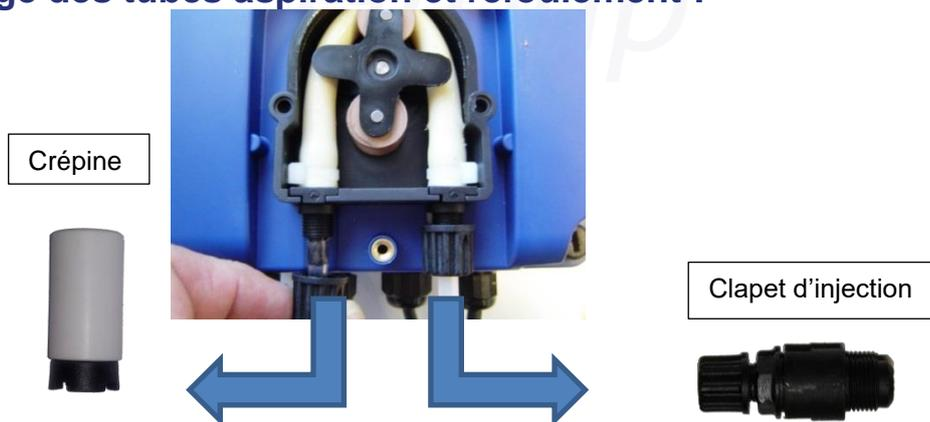
Le tube d'aspiration souple en PVC est plongé avec sa crépine dans le bidon de produit à injecter et est connecté sur la pompe (entrée de gauche). Ensuite resserrer l'écrou sur le raccord.
