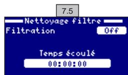
**7.5 Mode nettoyage du filtre** (et nettoyage de la piscine par aspiration) : Ce menu (accessible depuis n'importe quel mode de Filtration) permet de réaliser facilement un contre-lavage du filtre à sable. L'activation de ce menu depuis n'importe quel mode de filtration (Manuel, Automatique, Smart) a pour effet de déconnecter la cellule d'électrolyse/hydrolyse. Procédez ensuite comme suit :
