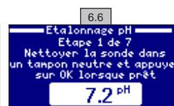
**6.6 Exemple de première étape d'étalonnage avec solutions tampons.**
