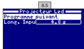
**8.5 Sélection de la couleur :** Ce menu permet de changer la couleur des projecteurs de votre piscine. L'option *Programme Suivant* permet de programmer le changement de couleur manuellement, et l'option *Longueur d'Impulsion* permet de sélectionner la fréquence des changements de couleur.
