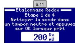
**6.11 Exemple de première étape d'étalonnage avec solution tampon.**
